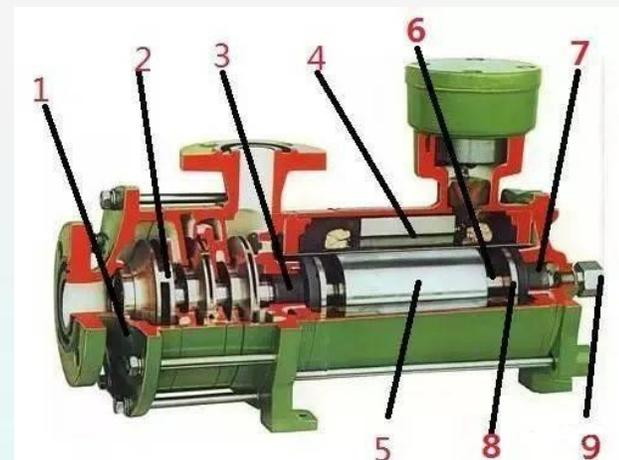
屏蔽泵结构示例图
