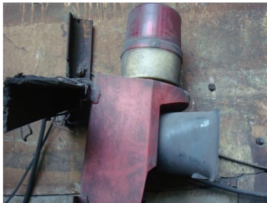
图 2-3 泥炮声光信号故障
