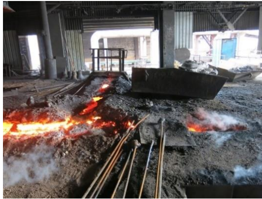
图 2-2 撇渣器上未设防护罩，渣口正前方未设挡渣墙
