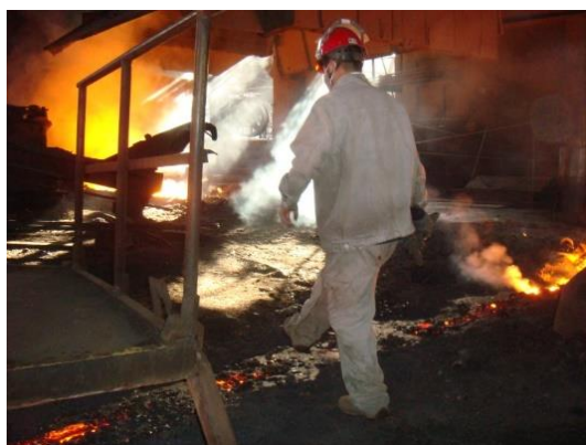
图 2-7 作业人员直接跨越渣、铁沟
