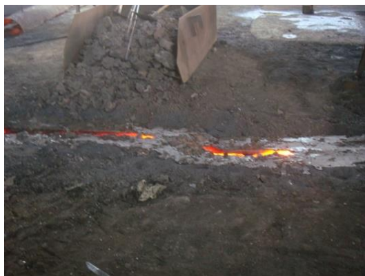
图 2-1 渣、铁沟无横跨用的活动小桥或盖板
